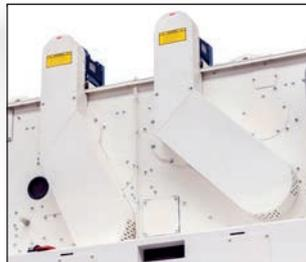
Les nettoyeurs série 150 sont équipés d'un système de séparation d'air en deux passages. La pré-aspiration est conçue pour ôter les poussières et petites impuretés à l'entrée de la machine et pour en réduire la quantité dans la machine. Cela garantit un flux régulier du produit sur les grilles. La post-aspiration est conçue pour collecter les enveloppes vides et les impuretés à la sortie finale du nettoyeur.
