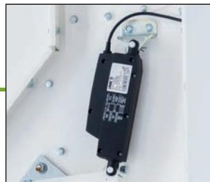
Les nettoyeurs série 150 peuvent être fournis avec un système de commande électronique. Le système se compose d'un panneau de commande qui fait fonctionner les actionneurs et moteurs avec contrôle intégré de la fréquence. Les actionneurs contrôlent de nombreuses trappes d'air à l'intérieur de la machine et les ajustements numériques allant de 0 à 100 permettent des réglages très précis. Le système de commande électronique inclut le réglage du secoueur d'alimentation.
